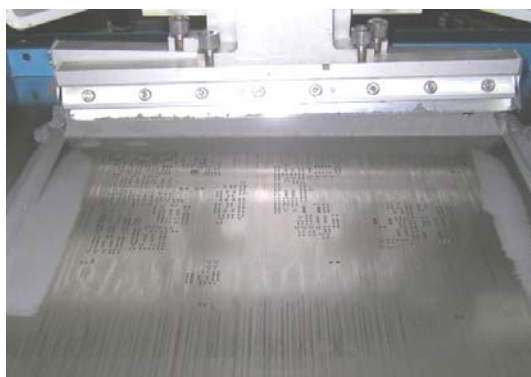
Fig.2.1.15. Șablon din oțel inoxidabil
