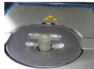
Fig. 2.3.13. Val selectiv prin imersare manuală
