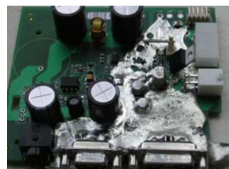
Fig. 2.3.18. Acumulare neuniformă de aliaj: a. La lipituri; b. Pe placa
