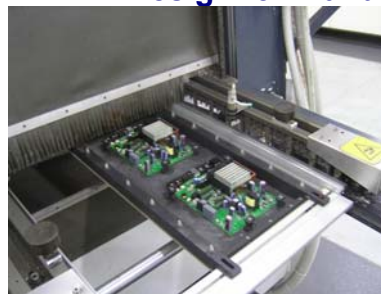
Fig. 2.3.6. Placa plantată pe cadru
