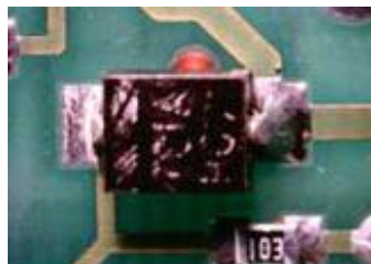
Fig. 2.3.18. Acumulare neuniformă de aliaj: a. La lipituri; b. Pe placa
