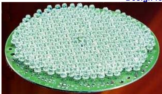
Fig.2.7.1. Circuit de cablaj imprimat pe suport metalic asamblat
